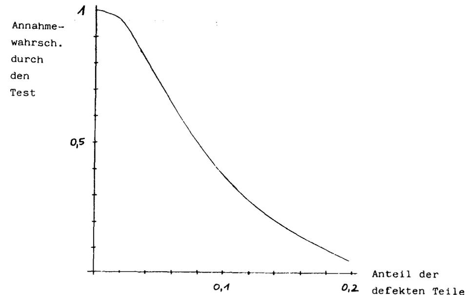
Dieser Kurve kann man für jede mögliche Qualitätsstufe der Produktion die Annahmewahrscheinlichkeit einer Sendung entnehmen. Eine Sendung mit 8 defekten Teilen wird demnach mit jeweils einer Wahrscheinlichkeit von 50 % angenommen bzw. abgelehnt.
