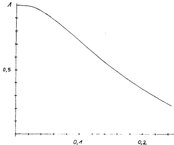
Verändert man die Annahmeregeln durch Erhöhung der Annahmezahl  $a$  z.B. von 1 auf 2, so vergrößern sich die Funktionswerte der zugehörigen Operationscharakteristik um den Summand  $\binom{D}{2} \binom{100-D}{8} : \binom{100}{10}$  so daß der Graph scheinbar nach rechts verschoben wird:
